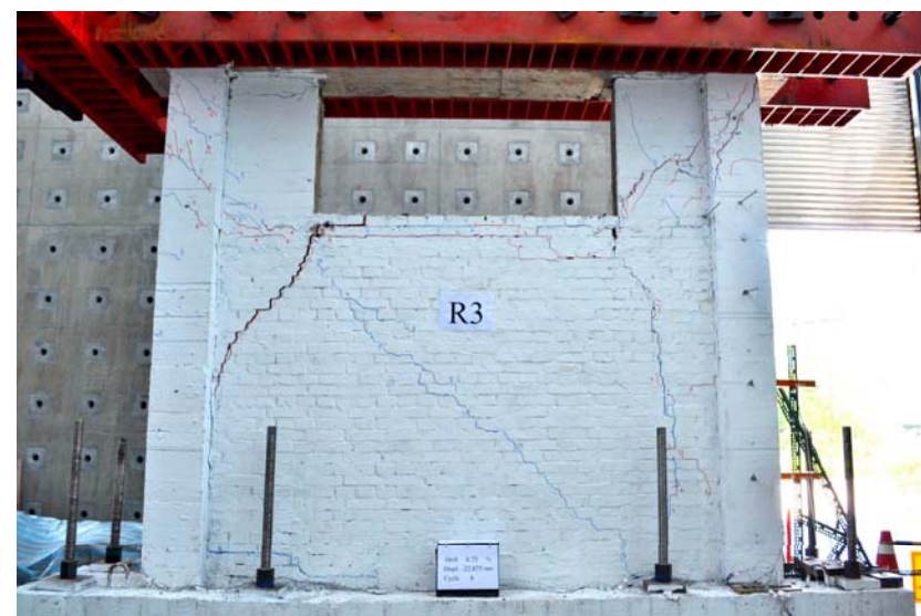
側位移比0.75%，磚牆形成一道完整裂隙且試體達水平側向力最大值
