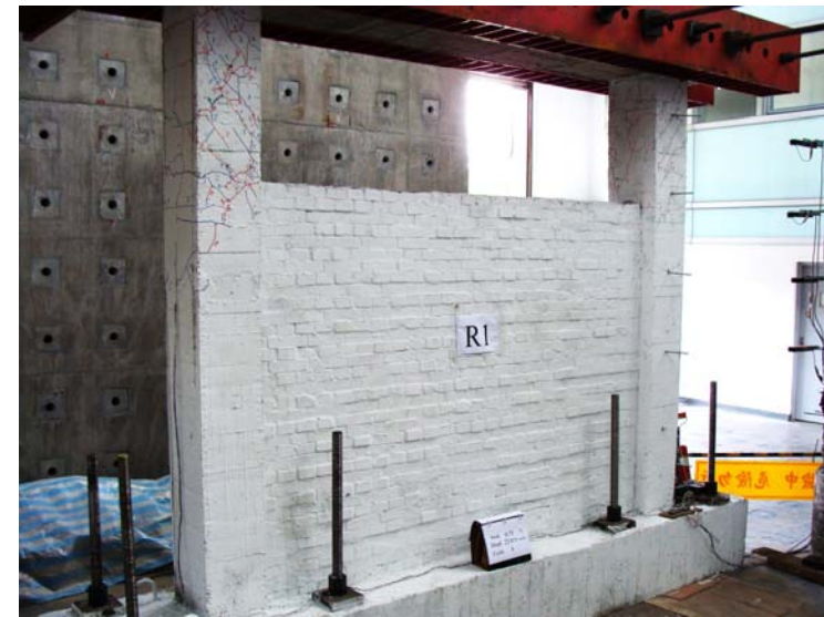
構架短柱區域剪力裂縫快速發展 (0.75%)
