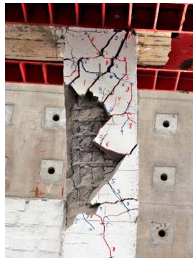
側位移比2%，試體達到極限牆度
